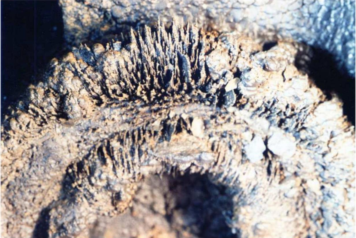
Reinigungseffekte in einer Anlage gefüllt mit hartem Leitungswasser (ca. 24°dH).
