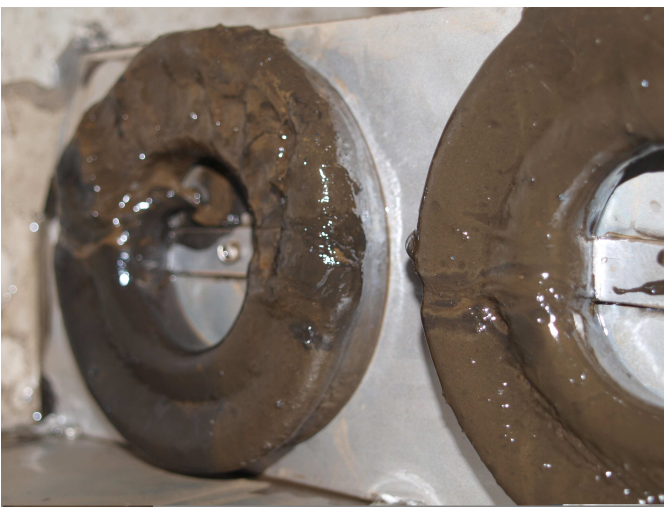
Magneteinsatz vor Reinigung
