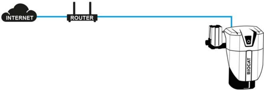
Sollte ein direkter Anschluss mittels LAN-Kabel (RJ45) von Ihrem BIOCAT-Kalkschutzgerät nicht möglich sein, können sie dies in den meisten Fällen mit einem Powerline Adapter-Set über die vorhandene Schuko-Steckdose realisieren. Wir empfehlen dazu folgendes Zubehör:
