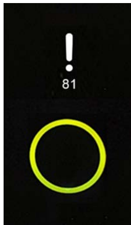
Warnung „81“ Batterie Schwach
