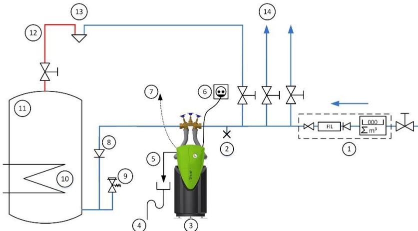
(1) Wasserzähler + Hauswasser-Station; (2) Entleerrahn; (3) Biocat KS Kalkschutzgerät; (4) Freier Auslauf in Abfluss; (5) Rückspülleitung (temperaturbeständig 80°C); (6) SCHUKO Steckdose; (7) optional: Einbindung in die Gebäude-Leit-Technik mittels Meldekontakt; (8) Rückschlagventil; (9) Überdruckventil; (10) Wärmetauscher; (11) Warmwasserspeicher; (12) Warmwasserverteiler mit Warmwassersteigleitung; (13) Wandbatterie; (14) Kaltwasserverteiler mit Kaltwassersteigleitungen;
