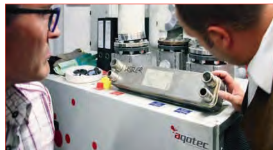
Lorenz Ammerer (l.) und Alexander Plesche inspizieren einen Wärmetauscher auf Kalkrückstände. ▼
