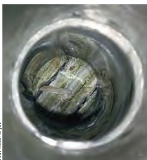
Blick in den Warmwasserabgang eines verkalkten Rohrbündelwärmeeübertragers vor dem Einbau der BIOCAT KS 5D Kalkschutzanlage
