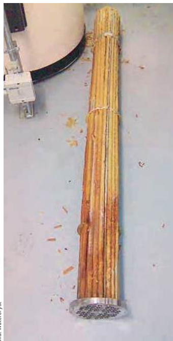
Verkalkter Rohrbündelwärmeeüberträger ohne BIOCAT
