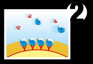
In den BIOCAT Kalkschutzgeräten befindet sich das WATERCryst Katalysator-Granulat mit Andockstellen für Calcium- und Carbonat-Ionen auf einer speziell entwickelten Oberfläche.
