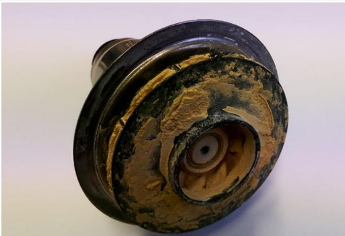
*Laufrad einer Trinkwasser-Zirkulationspumpe ohne Kalkschutz nach drei Monaten im Einsatz*
