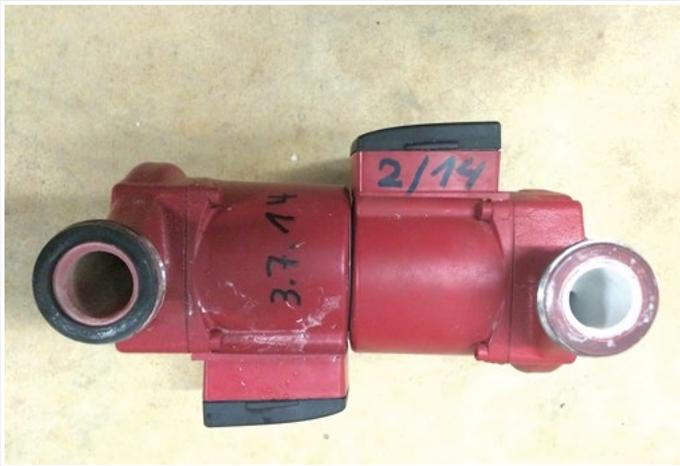
ausgebaute Zirkulationspumpe links nach 12 Monaten Betrieb mit BIOCAT KS 11000, rechts daneben nach drei Monaten ohne Kalkschutz
