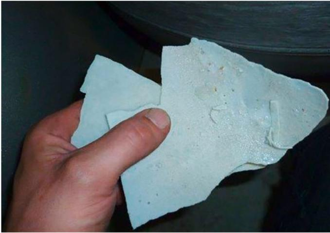
*Kalkplatte nach Öffnung des Trinkwasserspeichers vor BIOCAT Einbau*
